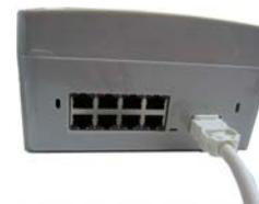
RJ45 Buchsen mit LED und 230V Anschluss
