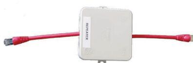
Übersteigt die Kommunikationsdistanz zwischen dem LST-VOC und dem Steuerungsmodul 70m, ist der Einbau eines LSR (Lift Status Repeater) Signalverstärkers erforderlich. Bei Anlagen mit Maschinenraum ist ebenfalls ein LSR erforderlich. Das LSR Verbindungsmodul wird bei Vorhandensein von mehreren LSR eingesetzt.
